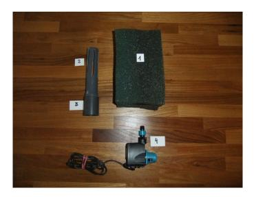
Alles zusammenbauen (der Nummerierung folgend). Ggf. die Pumpe mit Aquarium Silikon oder Kunststoffkleber (Tangit) mit dem Rohr verkleben.
